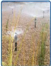
Mit Hilfe einer Pumpe strömt das Teichwasser, über Düsen zerstäubt, von oben nach unten durch das Filtersubstrat und wird anschließend wieder in den Teich zurückgebracht. Die feinen Poren des Filtersubstrates filtern kleinste Partikel, wie Algen und andere
