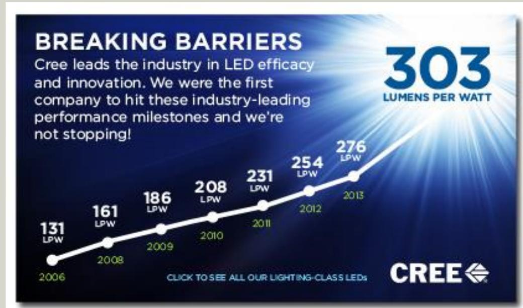
Der Hersteller CREE hat im März 2014 einen Laborwert von 303 lm/W erreicht. (Das physikalische Maximum liegt bei etwa 350 lm/W.)
