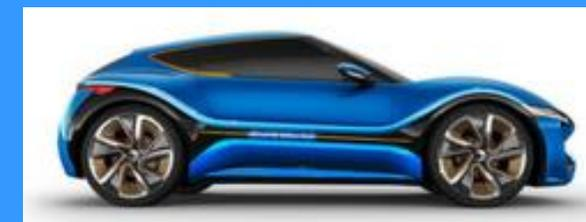
Der Niedervolt-Elektroflitzer Quantino mit Redox-Flow-Akku: 2 \* 175 l Tank
