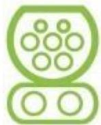
Der CCS-Stecker ergänzt den Typ 2-Stecker mit zwei zusätzlichen Leistungskontakten um eine Schnellladefunktion und unterstützt AC- und DC-Laden (Wechselstrom- und Gleichstromladen) mit bis zu 170 kW. In der Praxis liegt der Wert eher bei 50 kW.
