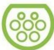
Tesla verwendet für seine Supercharger eine modifizierte Version des Mennekes-Stecker Typ 2. Diese erlauben eine Aufladung des Model S zu 80% innerhalb von 30 Minuten bei einer Ladeleistung von bis zu 120 kW (Gleichstrom). Die Ladung bietet Tesla kostenlos für seine Kunden an. Andere Autofabrikate können bislang nicht an Tesla Superchargern geladen werden.
