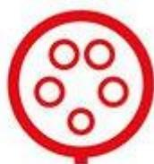
1. als einphasige, blaue Option, dem sogenannten „Camping“-Stecker mit einer Ladeleistung von bis zu 3,7 kW (230 V, 16 A)
